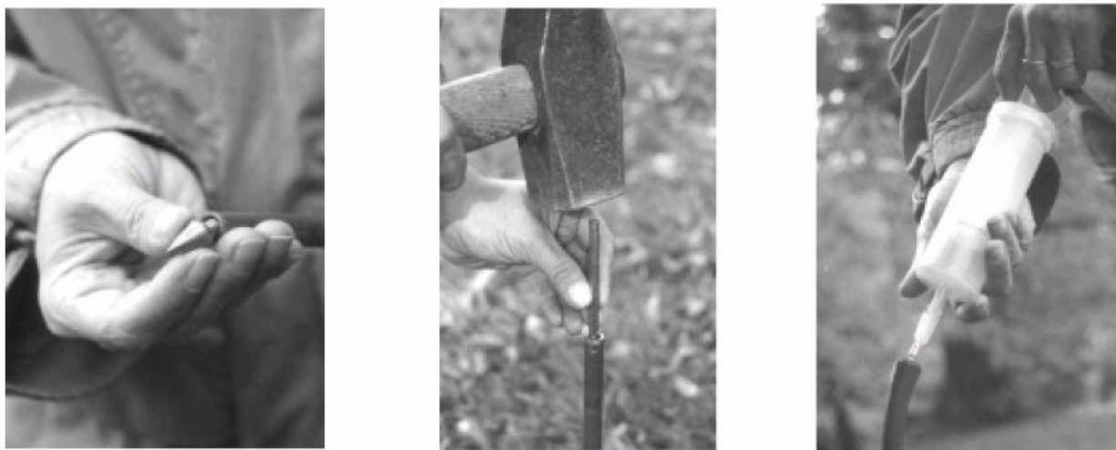
Рисунок 3 – Отбор пробы воздуха
